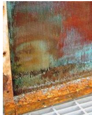
Effetti della corrosione su una batteria di scambio termico di tipo Rame-Rame
